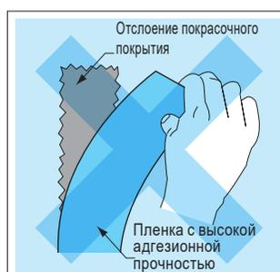
Если на поверхность фасадных панелей наносятся пленки с высокой адгезионной прочностью (например, тканевые ленты или скотч), покрасочное покрытие может отслоиться, либо на поверхности может остаться связующее вещество.
