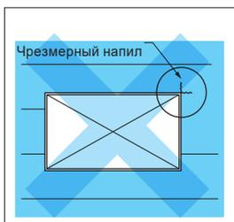
Это может привести к образованию трещин. Наличие чрезмерных напилы также может вызвать проникновение дождевой воды и, как следствие, повреждения при ее замерзании.
