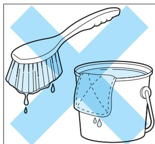
Если для очистки поверхности используется вода, на ней могут появиться светлые участки. Очищайте панель мягкой сухой тканью или щеткой
