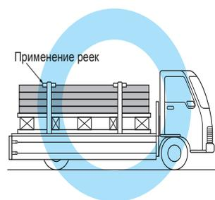
С целью предотвращения порчи панелей, которая может быть вызвана неожиданным торможением автомобиля, зафиксируйте панели стропами и вставьте рейки по углам.
